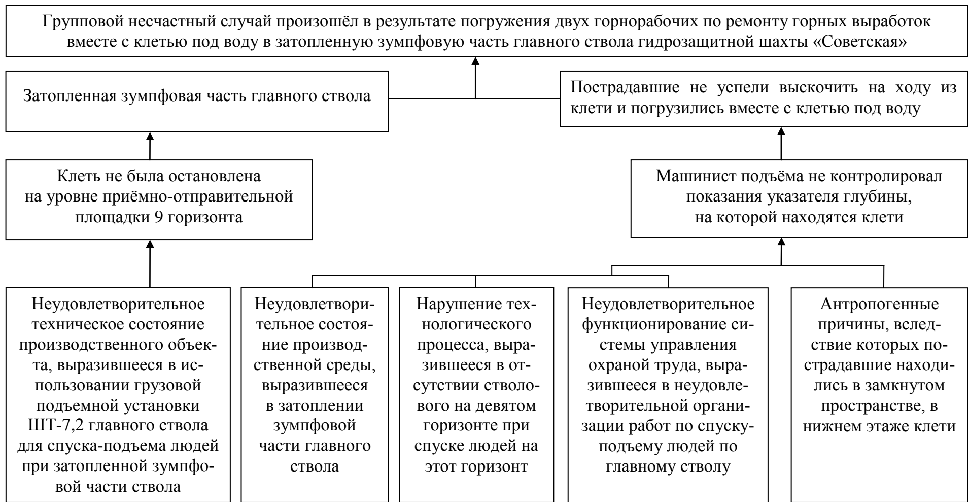
Рисунок – Схема причинно-следственных связей опасных событий, приведших к аварии с групповым несчастным случаем при спуске в шахту клетки по главному стволу гидрозашитной шахты «Советская»
